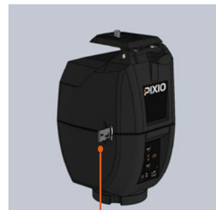
La tarjeta micro SD entra en la ranura del robot.
