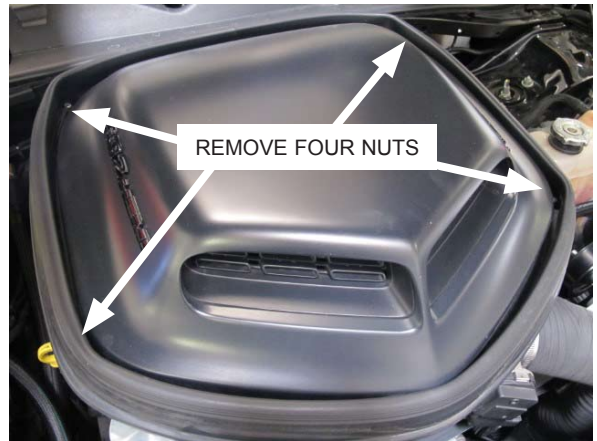
Fig. 2-n: Remove shaker scoop
