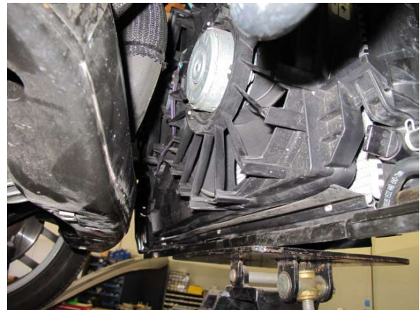
Fig. 2-q: Remove radiator fan assembly
