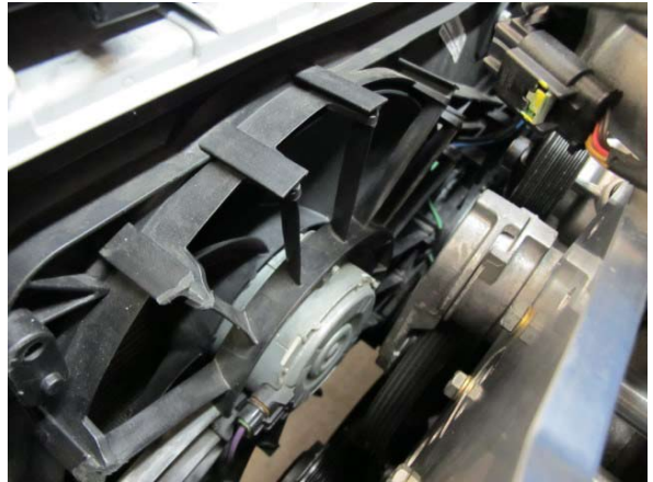
Fig. 4-a: Reinstall radiator fan assembly
