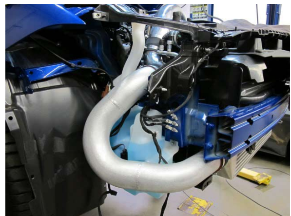
Fig. 6-aj: Install discharge tube B
