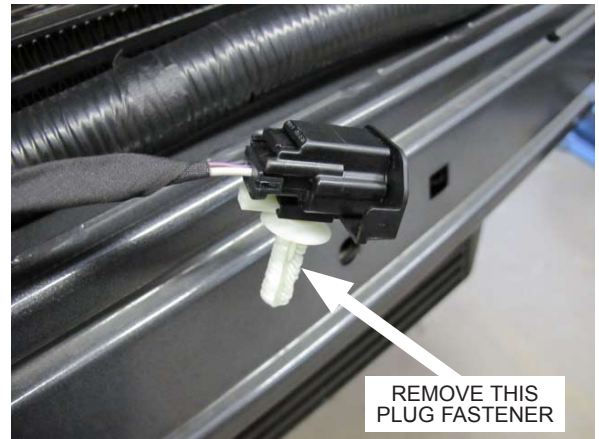
Fig. 6-z: Remove plug retainer
