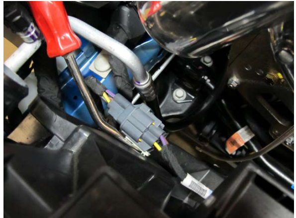
Fig. 6-m: Detach cooling fan connector from fan shroud
