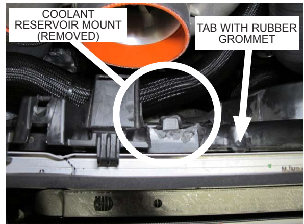
Fig. 1-ab: Modify fan shroud
