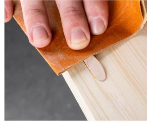
**1.** Vergewissern Sie sich, dass die Schrauben bis zum Anschlag in das Sackloch eingeschraubt sind, um die beste Passform zu erhalten, bevor Sie das Loch mit einem Holzdübel füllen.
