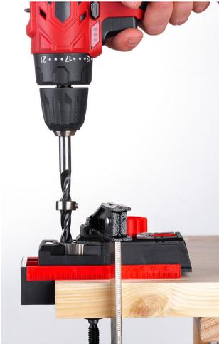
**3.** Um die Anschlaghülse des Bohrers einzustellen, messen und markieren Sie den Dübel knapp über der Hälfte seiner Länge. Richten Sie den Dübel gegen das Bit aus und platzieren Sie eine Anschlaghülse mit entsprechender Größe so, dass das vordere Ende der Anschlaghülse auf die Bleistiftmarkierung ausgerichtet ist.
