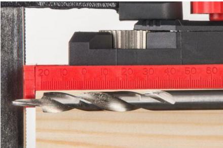
**3.** Entfernen Sie die Anschlaghülse vom Bohrer und verwenden Sie stattdessen das Ende des Bohrfutters als Anschlaghülse. Messen Sie 120 mm von der Schulter des Bit bis zum Bohrfutter und ziehen Sie das Bohrfutter fest.
