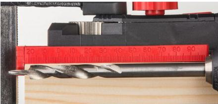
**3.** Entfernen Sie die Anschlaghülse vom Bohrer und verwenden Sie stattdessen das Ende des Bohrfutters als Anschlaghülse. Messen Sie 120 mm von der Schulter des Bit bis zum Bohrfutter und ziehen Sie das Bohrfutter fest.
