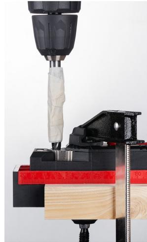
**4.** Für das Bohren von 10mm oder 12mm Dübellöchern empfehlen wir die Verwendung von Klebeband oder Abdeckband um das Bit herum, um die richtige Bohrtiefe anzuzeigen, weil die größeren Anschlaghülsen den Kunststoffteil der Bohrschablone erfassen können.
