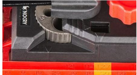
**2.** Stellen Sie die Schablone mit Hilfe der oberen Bohrtiefen-Messhilfe auf "27 mm" ein.
