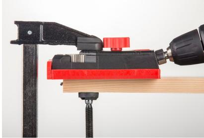
**3.** Bohren Sie, bis das Bit das Holz durchbohrt. Schieben Sie den Bohrer in die Führungslöcher und ziehen Sie den Bohrer mit einer Hin- und Herbewegung wieder heraus. Hierbei werden Fremdkörper beseitigt und Sie erhalten ein glattes Loch.
