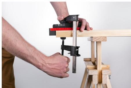
**3.** Drehen Sie den Griff, bis die Klemme fest mit dem Werkstück und der Arbeitsfläche verbunden ist. Überprüfen Sie vor dem Bohren nochmals, ob alles sicher befestigt ist. Drehen Sie zum Lösen den Griff gegen den Uhrzeigersinn.
