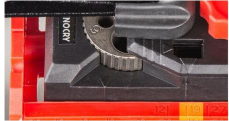
**2.** Stellen Sie die Schablone mit Hilfe der oberen Bohrtiefen-Messhilfe auf "19 mm" ein.
