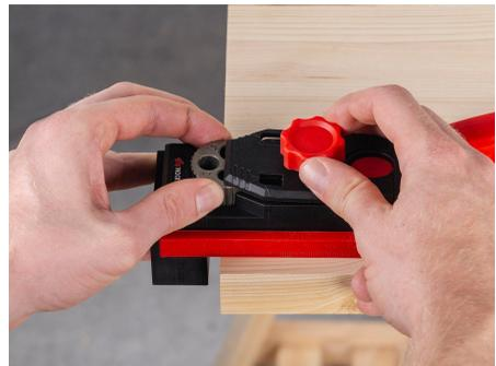
**1.** Markieren Sie den Mittelpunkt auf dem ersten Werkstück, in dem Sie den Dübel platzieren werden, mit einem Bleistift. Markieren Sie die Position des Dübels auf dem zweiten Werkstück. Stellen Sie sicher, dass sich der dicke schwarze Dübelstopper am Ende der Schablone befindet.
