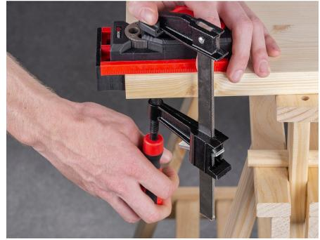
**1.** Je nachdem, welche Funktion Sie verwenden, achten Sie darauf, dass Sie den richtigen Stopper auf der Vorderseite der Bohrschablone fixieren und bündig mit dem Werkstück abschließen. Positionieren Sie die Schraubzwinde über der Bohrschablone.
