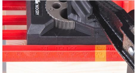
**2.** Stellen Sie die Schablone mit Hilfe der oberen Bohrtiefen-Messhilfe auf "38 mm" ein.
