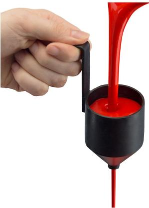
Füllen Sie den mitgelieferten Fließbecher bis zum Rand mit dem von Ihnen gewählten Material. Messen Sie mit Hilfe einer Stoppuhr, wie lange es dauert, bis sich der Fließbecher vollständig entleert.
