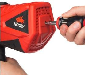
**1.** Ziehen Sie zuerst den Netzstecker aus der Steckdose. Lösen Sie dann die Schraube, um die Luftfilterabdeckung zu entfernen.
