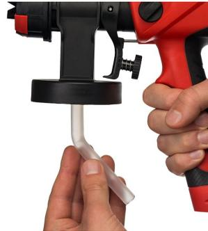
**Wenn Sie höher liegende Gegenstände und Oberflächen, wie z.B. eine Decke,** lackieren, drehen Sie das Saugrohr *in Richtung* des Gehäuses der Lackierpistole.
