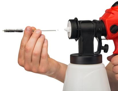
**2.** Entnehmen Sie die bereits eingesetzte Sprühdüse mit einem spitzen Gegenstand (beispielsweise mit der Rückseite der mitgelieferten Reinigungsbürste).
