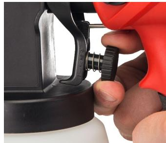
**Für dünnere Farben (weniger als 50 DIN/s)** - drehen Sie das Rad gegen den Uhrzeigersinn (ziemlich weit raus), um den Farbfluss zu reduzieren.
