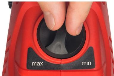
**Für dünnere Farben (weniger als 50 DIN/s)** - drehen Sie den Schalter gegen den Uhrzeigersinn auf Minimum. Ideal, wenn Sie einen gleichmäßigeren, gezielteren Farbstrom benötigen.
