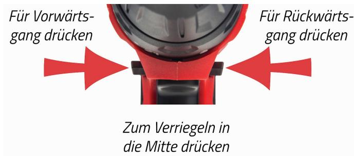
Auf beiden Seiten des Drehrichtungsschalters befinden sich Richtungspfeile, die den Vorwärts- und Rückwärtsgang kennzeichnen.
