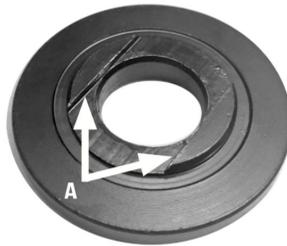
2. Platzieren Sie die Schleif- oder Trennscheibe auf der inneren Flanschscheibe und richten Sie das Bohrloch an der Kante aus.
