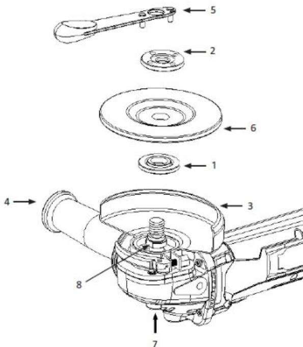
**1.** Innere Flanschscheibe **2.** Äußere Flanschscheibe **3.** Schutzschild **4.** Griff **5.** Anziehschlüssel **6.** Schleif-/Trennscheibe **7.** Spindelverriegelungstaste **8.** Spindel
