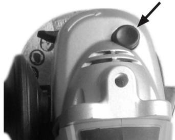
4. Nachdem die Scheibe befestigt ist, lassen Sie die Schleifmaschine einige Minuten bei niedriger Geschwindigkeit laufen, ohne die Scheibe gegen einen Gegenstand zu drücken. Wenn Sie während dieses Testlaufs Schäden an der Scheibe feststellen, ersetzen Sie sie sofort.
