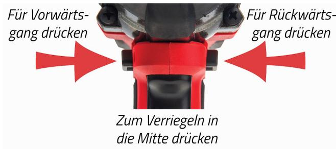
**Elektrowerkzeuge sind immer funktionstüchtig**, weshalb es wichtig ist, **dass Sie den Drehrichtungsschalter in die Mittelstellung drücken**, wenn Sie das Werkzeug nicht benutzen oder tragen.
